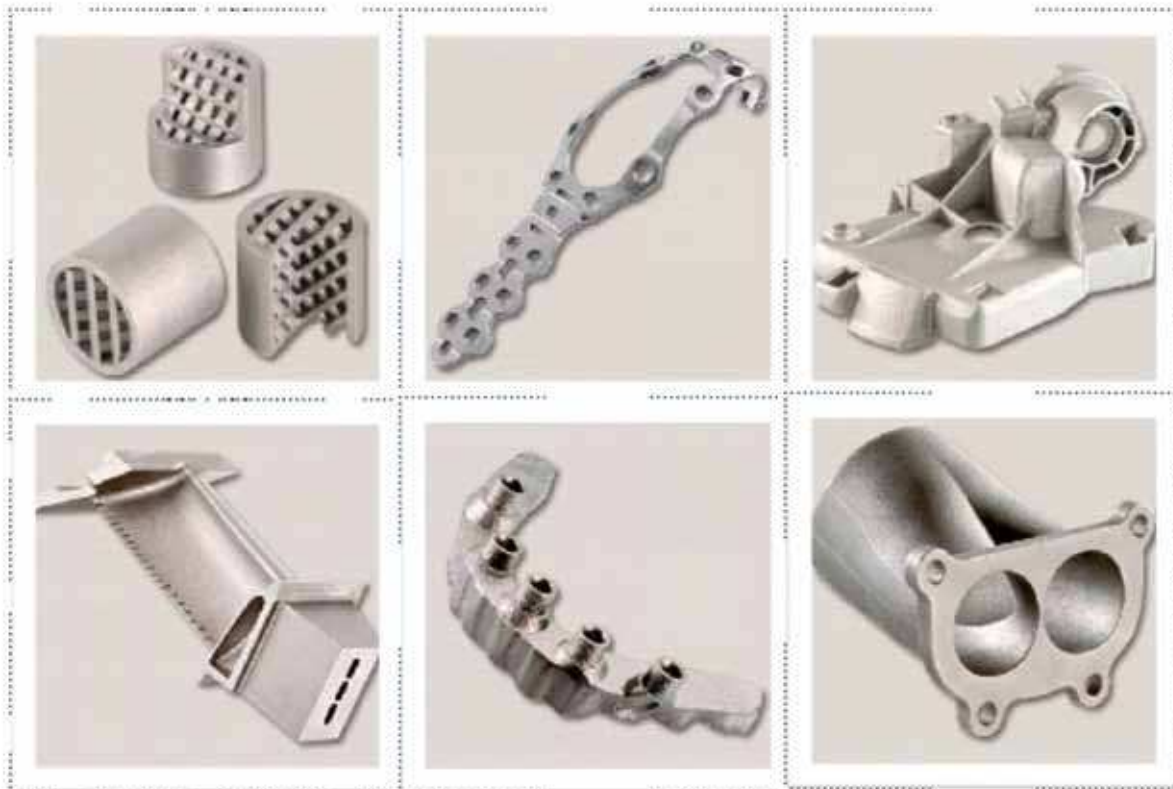
Afbeelding 6: voorbeelden van SLM producten van roestvast staal en nikkellegeringen.
