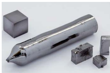
Een enkelkristal tantaal met daarnaast een kubus tantaal van 1 cm 3 . De oxidehuid is uitzonderlijk resistent (beelden zonder credits bron: internet)
