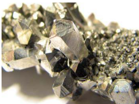
Kristallen niobium. Niobium is goed bestand tegen natriumdampen bij hoge temperaturen en drukken
