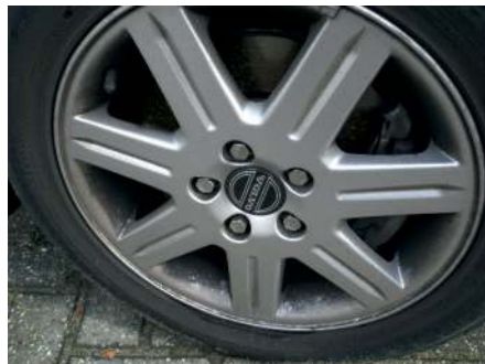
Afbeelding 10 Een vervuilde en aangetaste aluminium velg van een autowiel.
