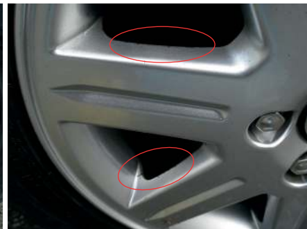
Afbeelding 11 De randen zijn aangetast door remstof en ander vuil (zie in de elipsen).
