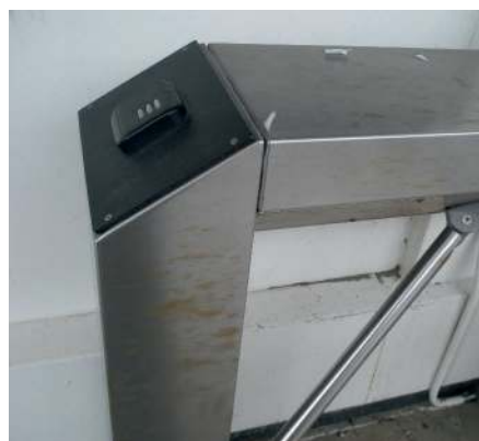
Afbeelding 3 RVS 316-toegangspoort dat aangetast is door aerosolen.
