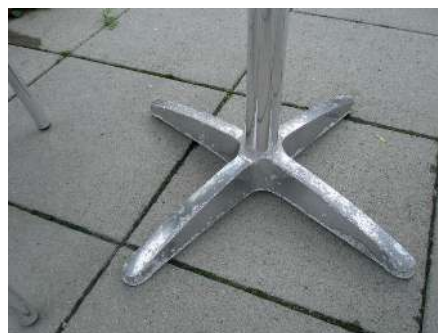
Afbeelding 2 Aangetaste aluminium poten van een terrastafel door aerosolen.
