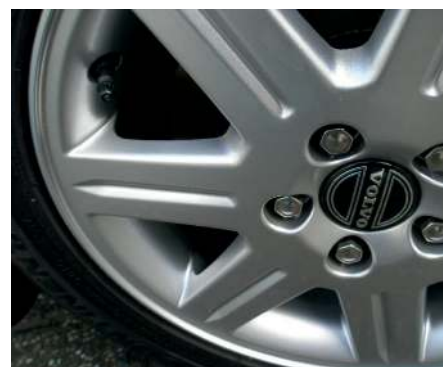
Afbeelding 12 Dezelfde velg maar na reiniging met de genoemde organische reiniger gevolgd door het opbrengen van een beschermlaagje op nanoschaal.
