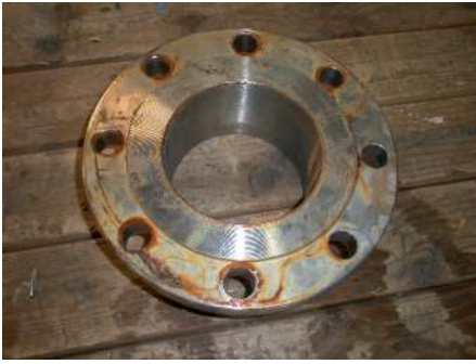
Afbeelding 4 RVS 304-flens die besmet is door ijzerhoudend water.
