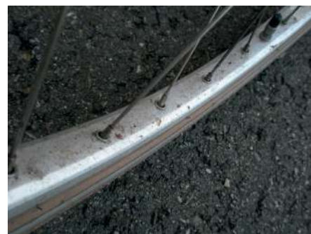
Afbeelding 8 Een aluminium fietswielvelg die door het gebruik zwaar vervuild en gecontamineerd is.
