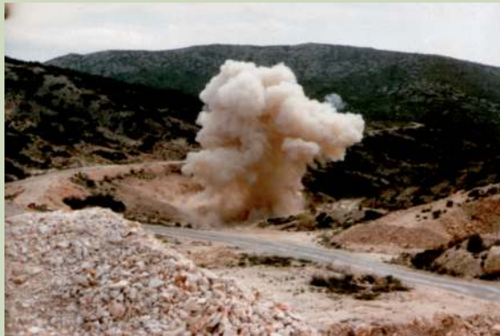
Afbeelding 1: explosief plateren in de open lucht dat ook wel gemakshalve een atmosferische cladding wordt genoemd (Foto Innomet B.V.).
