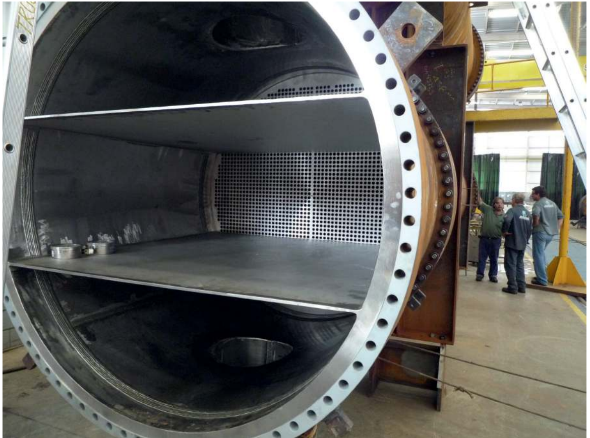
Afbeelding 8: warmtewisselaar met gecladde pijpenplaat en romp. De basis is koolstofstaal en de cladding is superduplex (Foto SMT B.V.).
