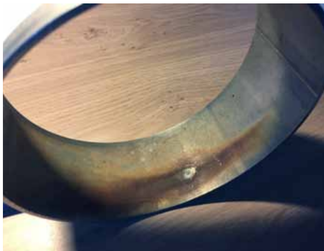
Afbeelding 4: zicht op de binnenkant van een door MIC doorboorde 316Ti pijp gevuld met IJ-water met de afmeting 6"Stos (foto Innomet b.v.).
