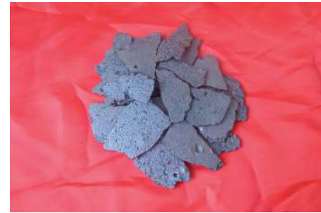
Flakes vanadiumpentoxide ( V_2O_5 ) met afmetingen niet groter dan 55 mm x 55 mm en 5 mm dik worden ondermeer toegepast als legeringsadditief (foto: bhshanqing.com)
