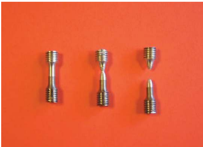
Afbeelding 3 Duidelijk is te zien dat de overgang aluminium/staal in tact blijft bij de trekproef.
