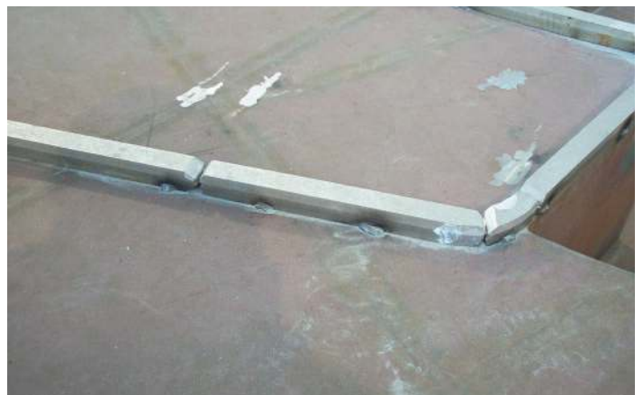
Afbeelding 13 Stompe overgangen die klaar zijn om gelast te worden.
