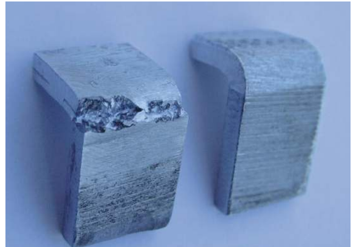
Afbeelding 2b Resultaten van de Hammer Bend Test. Links is een monster dat geclad is in de open lucht en rechts is het vacuüm gecladde Triplate te zien.
