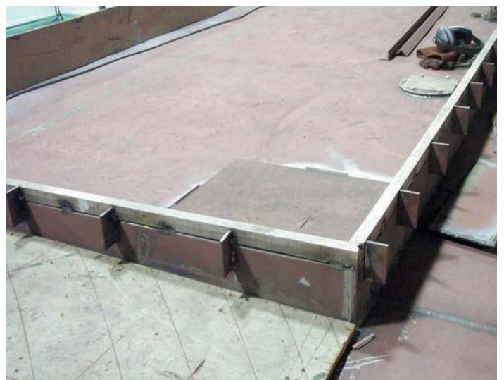
Afbeelding 5 Het dek van het jacht zoals afgebeeld in afbeelding 4 is reeds voorzien van de Triplate verbindingstroken. (Moonen Shipyards Den Bosch)
