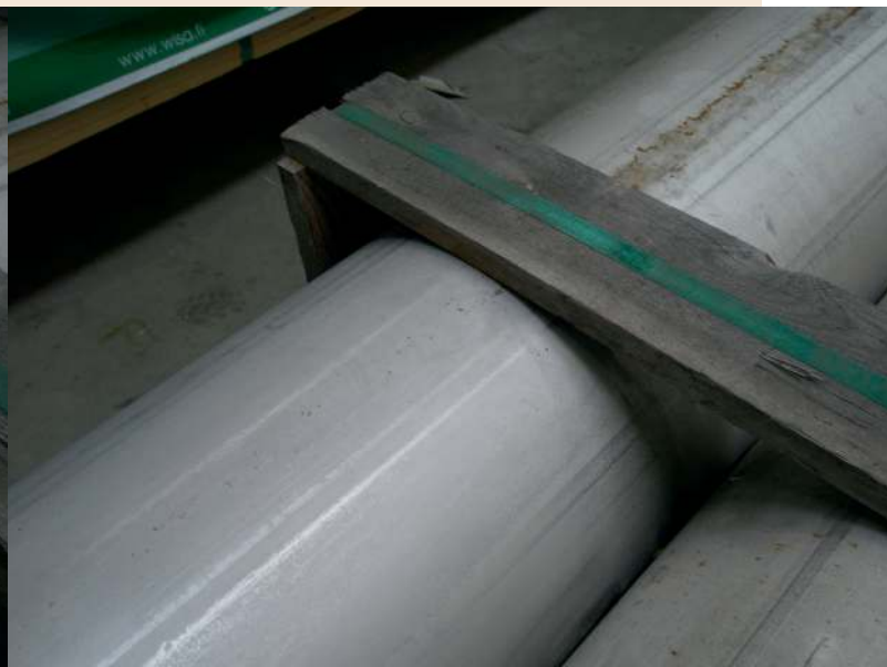
Afbeelding 8 Besmette RVS 316-buis, echter aan de linkerkant van de balk schoongemaakt.
