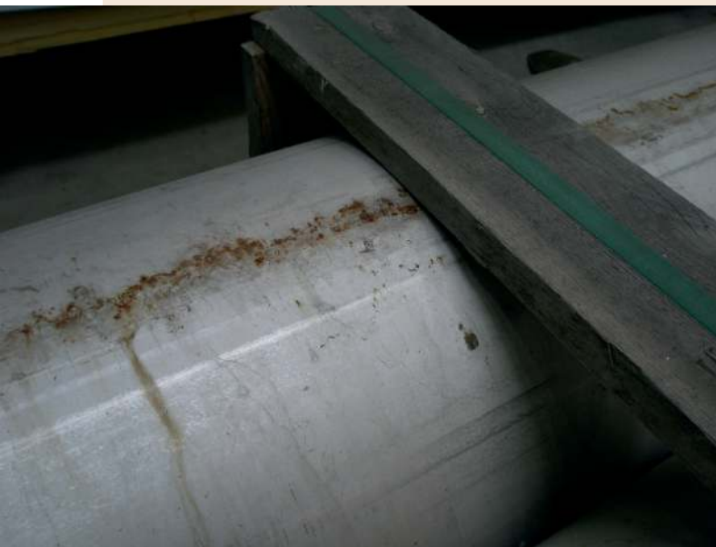
Afbeelding 7 RVS 316-buis die op een bouwplaats zwaar besmet is geraakt door staalgruis.
