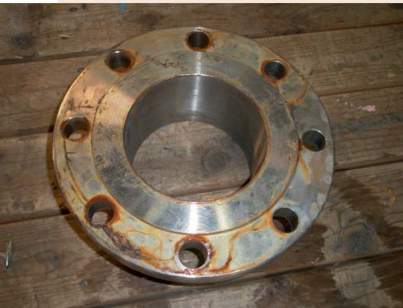
Afbeelding 5 RVS 304-flens die besmet is door ijzerhoudend water.
