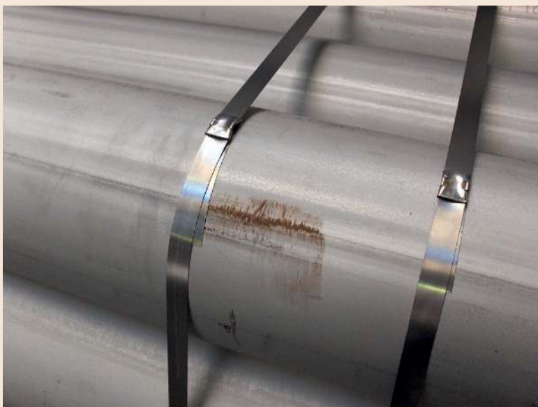
Afbeelding 3 Contaminatie door een stalen voorwerp zoals de vork van een heftruck.
