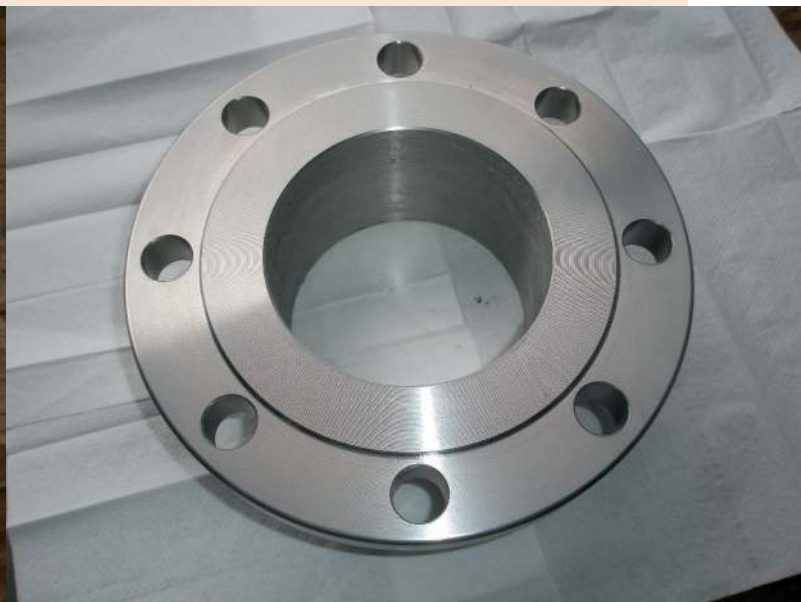
Afbeelding 6 Besmette RVS 304-flens, maar dan gereinigd met Innosoft B570 en voorzien van een nanolaagje.
