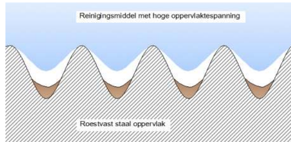
Afbeelding 6: reinigingsmiddel komt niet bij de bruinegekleurde vuilafzettingen in de poriën.
