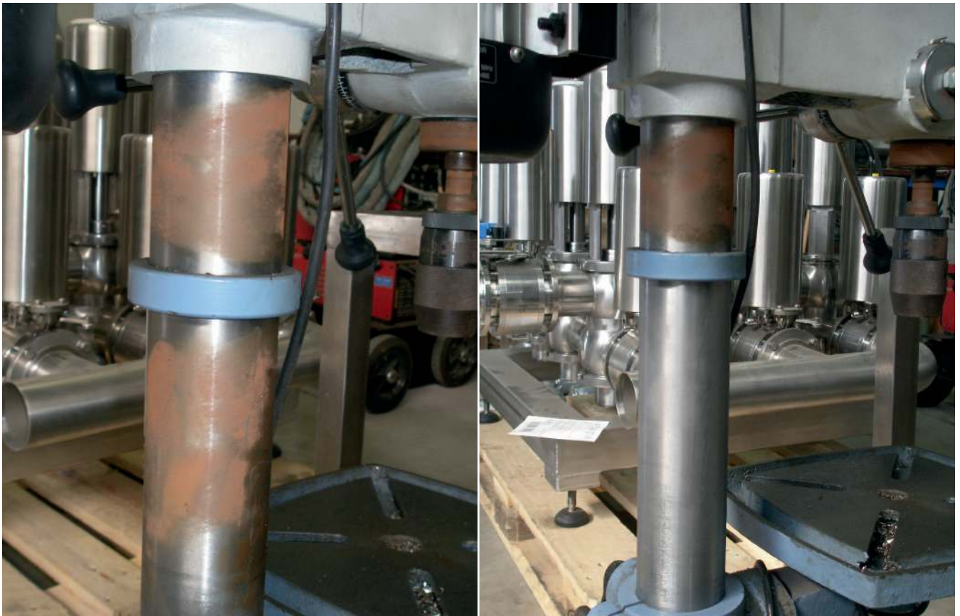
Afbeelding 11. (links) Een geroeste stalen boorkolom. Afbeelding 12. Alleen het onderste deel is behandeld met Innosoft B570.
