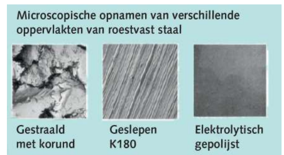
Afbeelding 1. Diverse opnamen van oppervlaktecondities onder de microscoop gezien (foto Packo).
