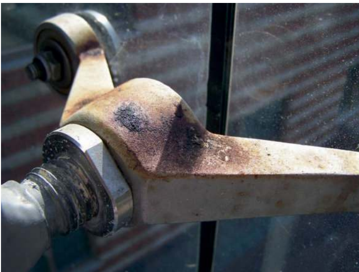
Afbeelding 3. Zwaar aangetast roestvast staal gietwerk door aerosolen.
