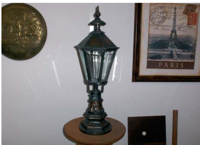
Afbeelding 5 Een stalen lantaarn voorzien van een bronzen deklaag.
