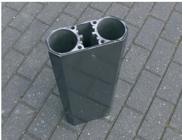
Afbeelding 7 Aluminium deel voorzien van een laag RVS-composiet.
