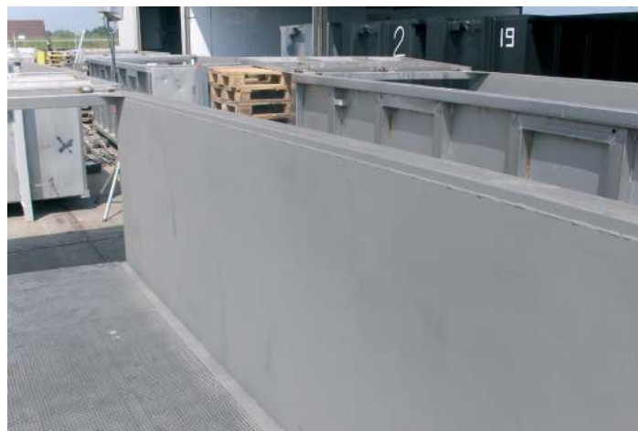
Afbeelding 6 RVS-verwateringsbak van AISI 304 t.b.v. schelpdieren, voorzien van een AISI 316-composiet.
