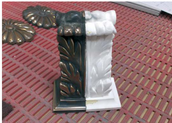
Afbeelding 3 Een ornament van gips dat voor de helft is voorzien van een bronzen deklaag.
