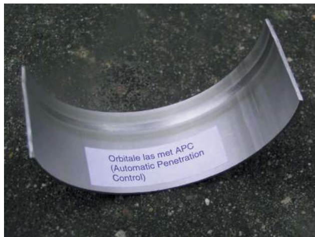
Afbeelding 4 Een perfecte doorlassing dankzij APC (Automatic Penetration Control).
