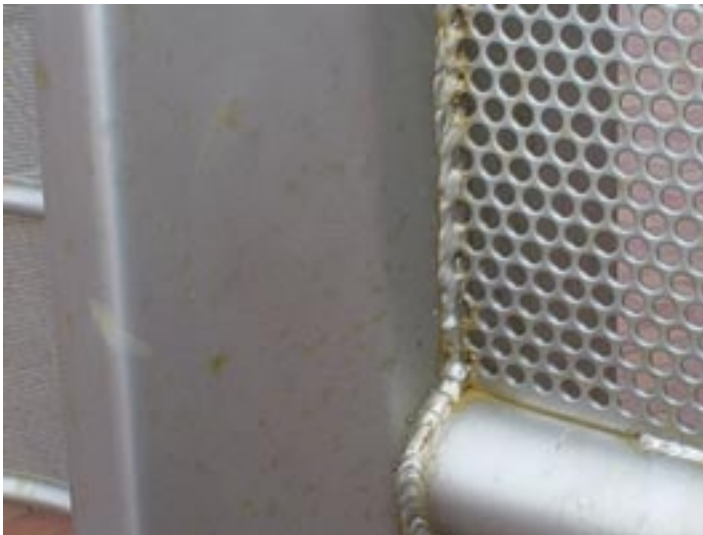
Afbeelding 3 Na een maand was er al vlogroest zichtbaar en dat vooral bij de lassen.
