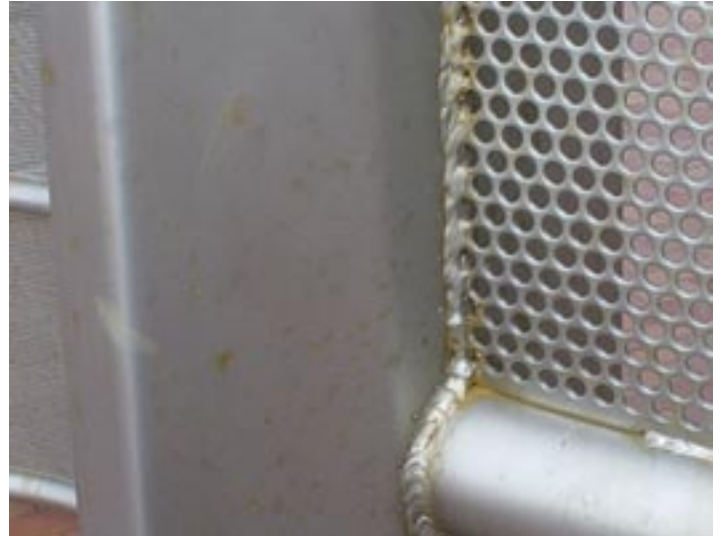
Afbeelding 5 Roest komt tussen de spleten uitzetten.
