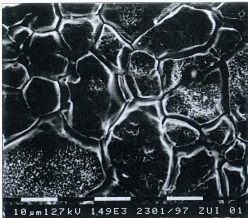
Afbeelding 1: Microscopische opname van een gebeitst roestvast staal AISI 316L oppervlak. Duidelijk is de 'kanaalvorming' te zien op de korrelgrenzen. V = 1500\times . (Foto: Dockweiler Nederland)
