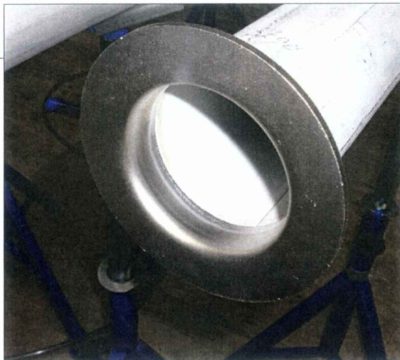
Afbeelding 7. Sanitaire doorlassing dankzij digitaal orbitaal lassen met doorlassensor.
