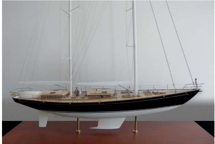
Afbeelding 7. De romp van dit jacht is gemaakt van duplex roestvast staal 1.4462 en voorzien van intelligente anodes.
