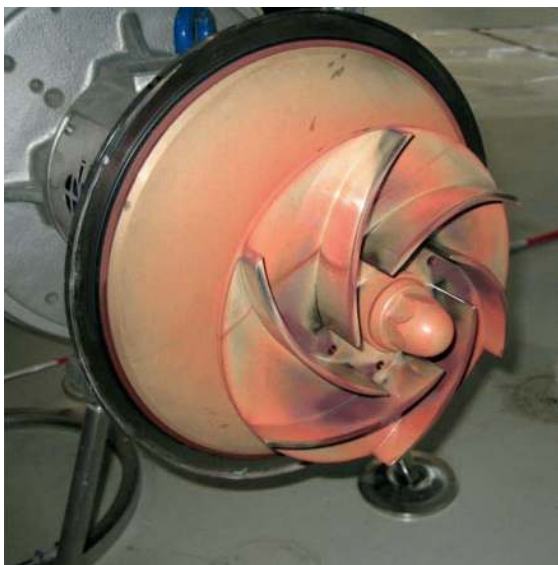
Afbeelding 3. Een RVS-pompwaaier die door rouging rood geworden is.
