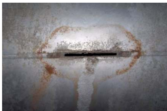
Afbeelding 4. De langснаadlas van een RVS-buis is aangevreten door zwavelreducerende bacteriën.
