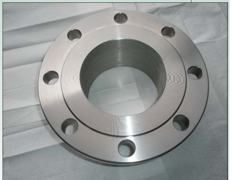
Figuur 6. Besmette Rvs 304 flens, maar dan gereinigd en voorzien van een nanolaagje.
