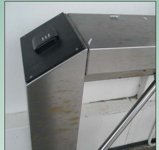
Figuur 2. RVS 316 toegangspoort die aangetast is door aerosolen.
