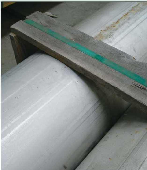
Figuur 8. Besmette RVS 316 buis, echter aan de linkerkant van de balk schoongemaakt.
