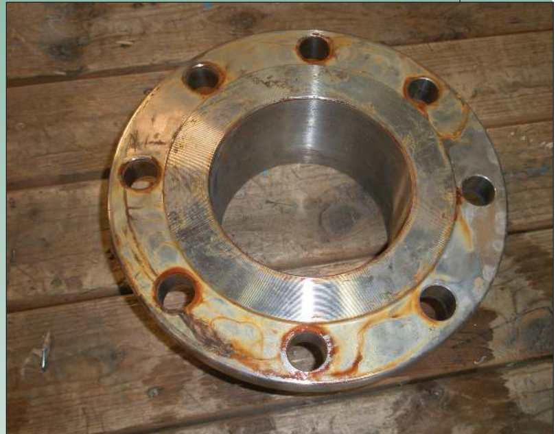
Figuur 3. Contaminatie door een stalen voorwerp zoals de vork van een heftruck.
