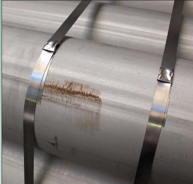
Figuur 3. Contaminatie door een stalen voorwerp zoals de vork van een heftruck.
