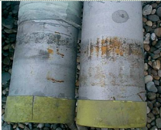
Contaminatie op buizen van roestvast staal door koolstofstaal
