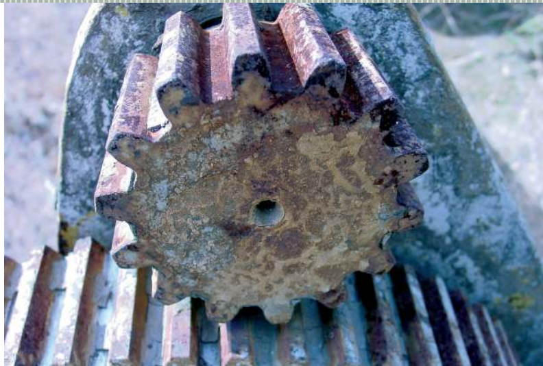
Als machines onder zware omstandigheden draaien ontstaat door roestvoering ernstige machineschade
