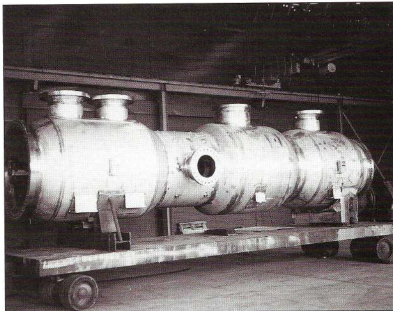
■ De afmetingen van deze 'reheater' van Incoloy 800H heeft een diameter van 1840 mm, een wand-dikte van 24 mm en een totale lengte van 8600 mm (foto: AKF BV, Goes)
