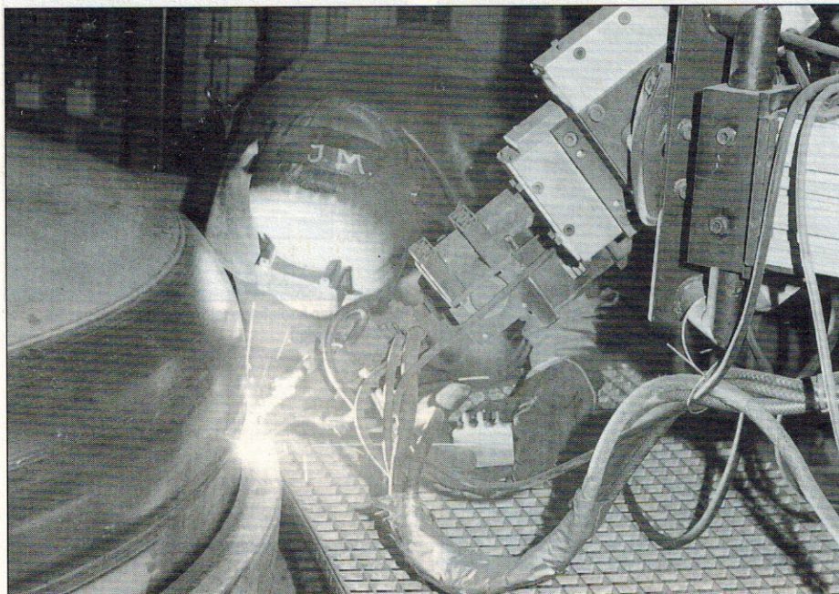
MIG-lassen van een hoeklas van rvs-deksel (Hoefnagel v. Meyn br).
