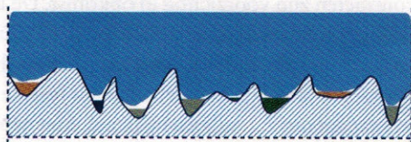
Schematische voorstelling van een waterige oplossing met een relatieve hoge oppervlaktespanning. De poriën worden niet bevochtigd waardoor het vuil niet wordt opgelost door het aanwezige detergent.
