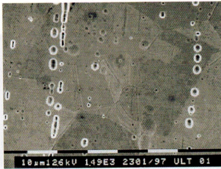
Afb. 3 Elektrolytisch gepolijst roestvast staal (316L). Het oppervlak vertoont geen kanaalvorming meer. V = 1500x
