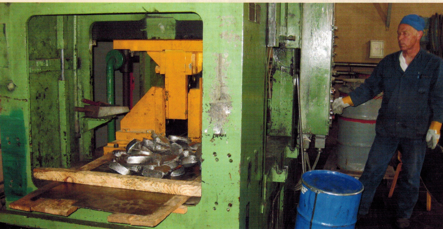
Productie van tantaal halffabrikaat bij Silmet in Estland. Na het gieten en uitkristalliseren in een ingot, wordt het tantaal in 'wafers' geknipt die naar de eindgebruiker gaan. Het tantaal o Silmet produceert wordt ingezet als legeringselement (foto: www.resourceinvestor.com )
