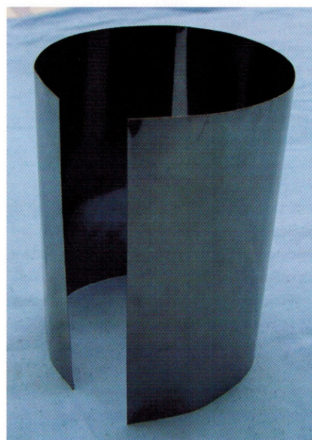
Vanwege de hoge prijs van tantaal wordt het veelal uiterst dun toegepast. Dit materiaal wordt aangeboden met een puurheid van 99,8% en een dichtheid van 16,65 gr/cm 3 (foto: gd-wholesale.com )
