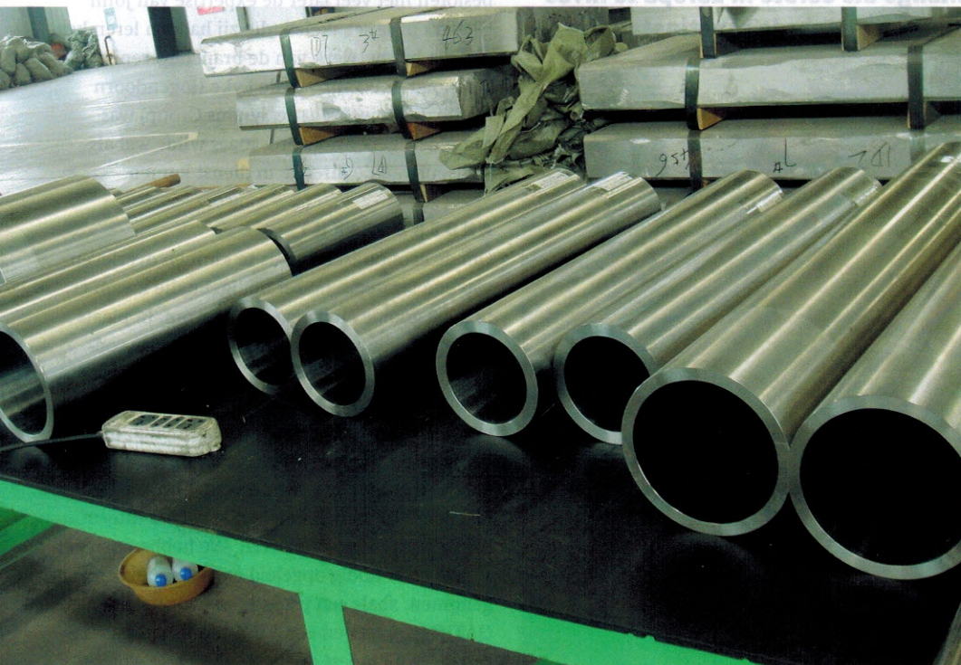
Dikwandige titaanbuizen, die als mantel dienen voor hydraulische cilinders van titaan grade 5. Ze zijn vervaardigd door Titan Projects in Sneek ten behoeve van de Noorse offshore.
