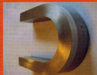
Triplate buigproef 180° met een buigradius van kleiner dan twee maal de stripbreedte
