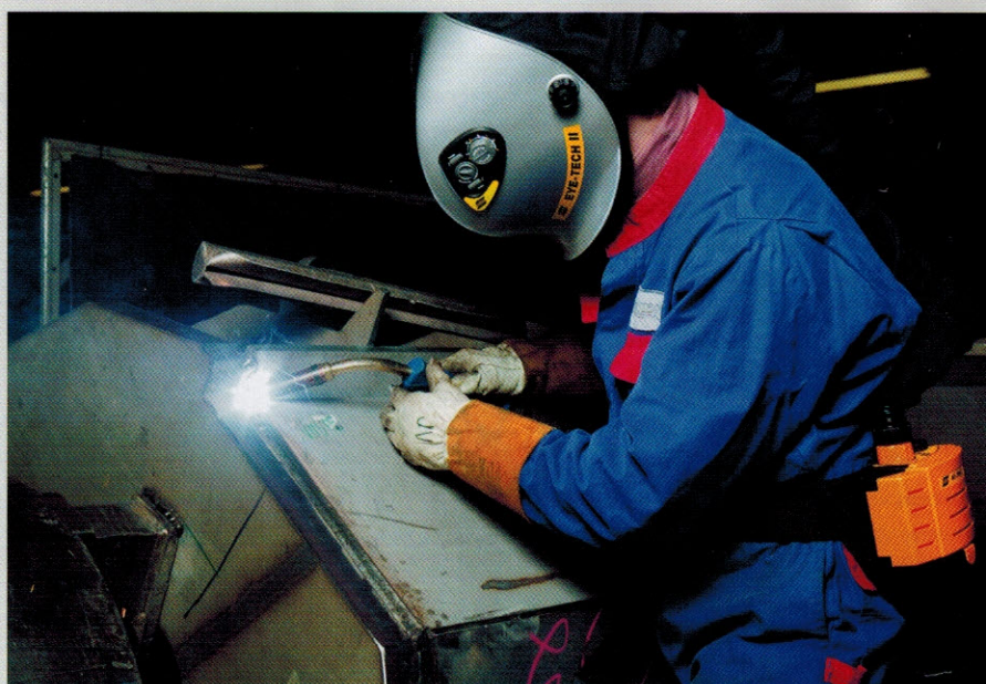
Roestvaststaal is een materiaal dat zich uitstekend laat lassen mits de juiste condities in acht worden genomen. (foto: Esab France Benelux)
