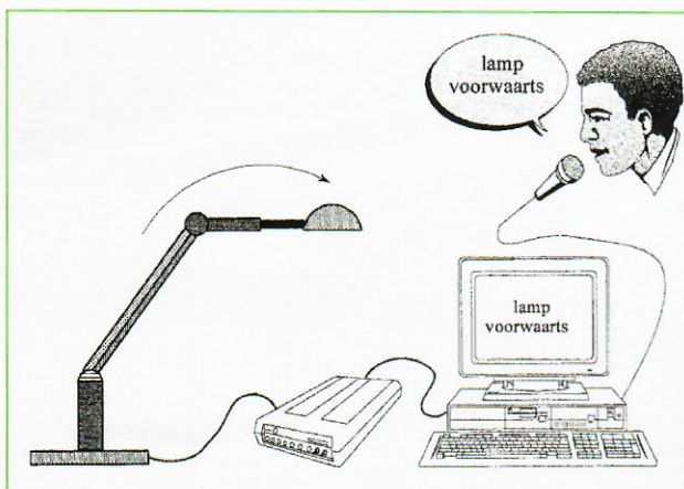
Afbeelding 6 Lamprobot met kunstspieren van geheugenmetaal
