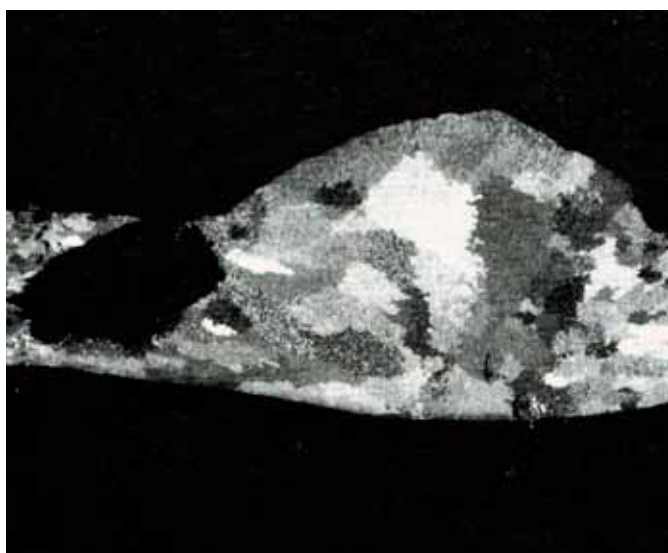
Afbeelding 7. Zware putcorrosie, net naast de las.
