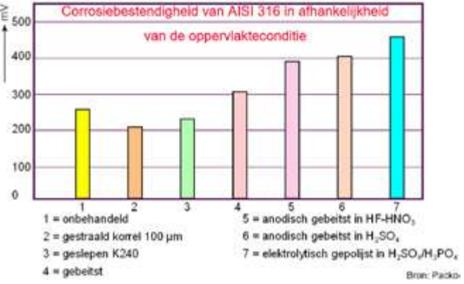
Afbeelding 8: De potentiaal van verschillende oppervlakcondities van RVS-316(L).
