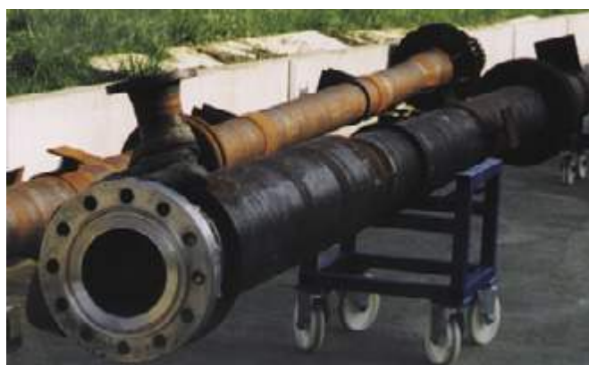
Reactoren voor de polymeerchemie, inwendig elektrolytisch gepolijst voor hoge weerstand tegen aankleven.
