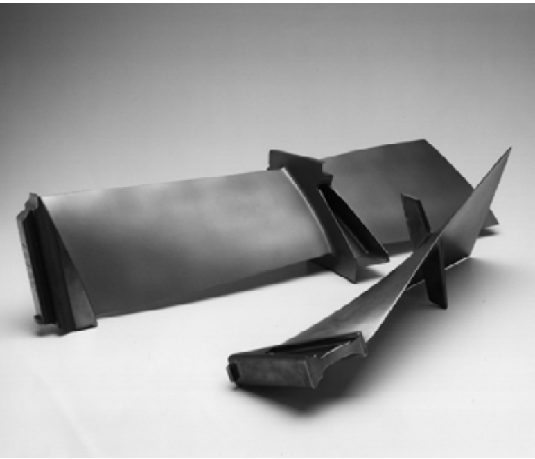
Afbeelding 5. Dankzij een opgespoten coating van wolframcarbide (0,25 mm dik) werd het invreeteffect op deze titaanschoepen vertraagd van 100 uur naar 30.000 uren. Het slijteffect op de basis van deze schoepen werd nagenoeg geheel opgeheven door een galvanisch opgebrachte koper-nikkel-indium laag. Bron: Courtesy Praxair Surface Technologies Ltd. en Timet UK.
