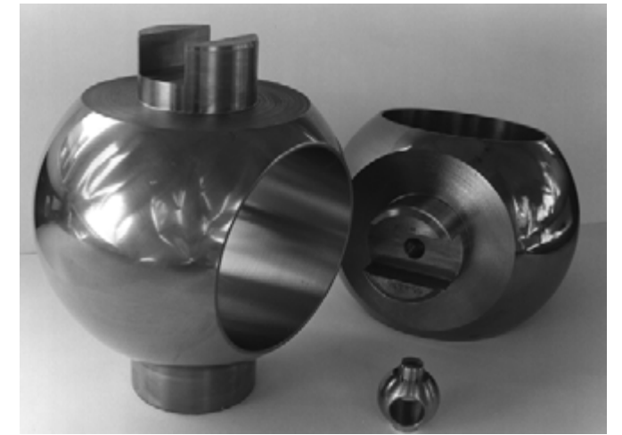
Afbeelding 4. Genitreeerde titaankogels t.b.v. afsluiters waardoor er een uitstekende combinatie ontstaat van slijt- en corrosiebestendigheid met bovendien een lage wrijvingscoëfficiënt. Bron: Courtesy Tecvac Ltd. en Timet UK
