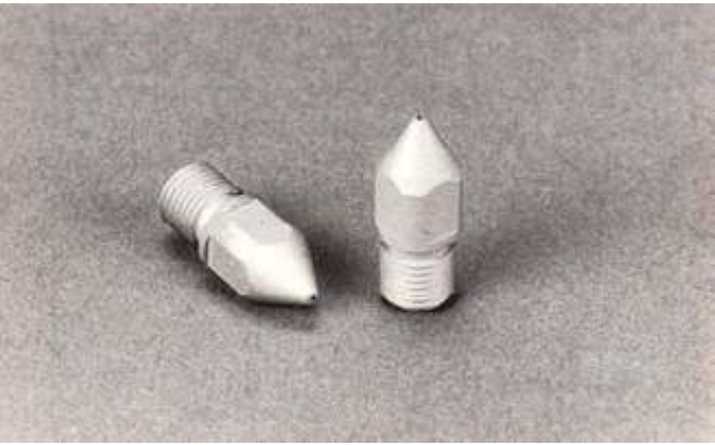
Afb. 1 Verfspuitmond met 3 \mu\text{m} dikke titaannitride CVD-deklaag; materiaal AISI 316.
