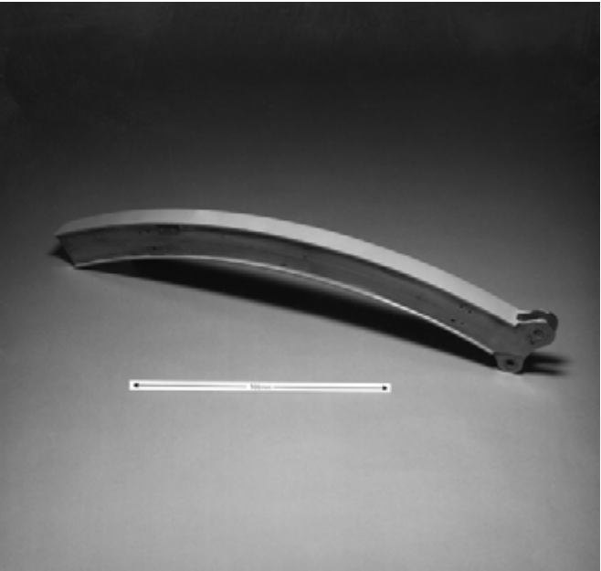
Titaan onderdeel van een vleugelklep van een Lockheed Tristar vliegtuig in de kwaliteit Ti-6Al-4V. Nadat deze ‘flaptrack’ was gerepareerd m.b.v. oplassen is deze gesprayed met een kobaltpoeder (87%), waardoor er een slijtlaag van 200 - 300 micron ontstond. Bron: Courtesy TWI, Marshall Aerospace en Timet UK.
