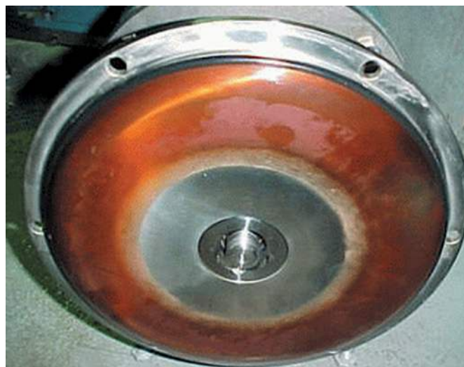
Afbeelding 2: rouging op een RVS-component.
